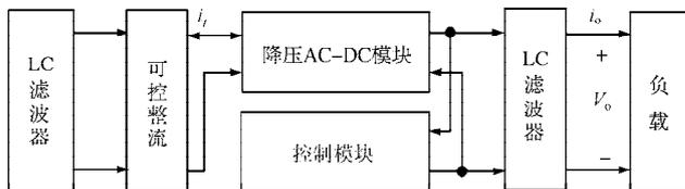
图7 整流模块部件框图
