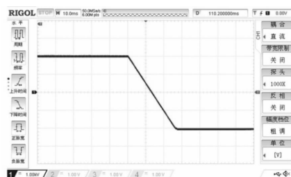
(a) 传统预测电流控制的转速响应波形
