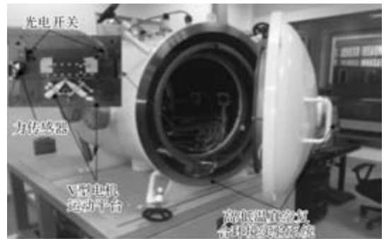
图 6 测试 VLUSM 在真空环境下输出特性实验平台
