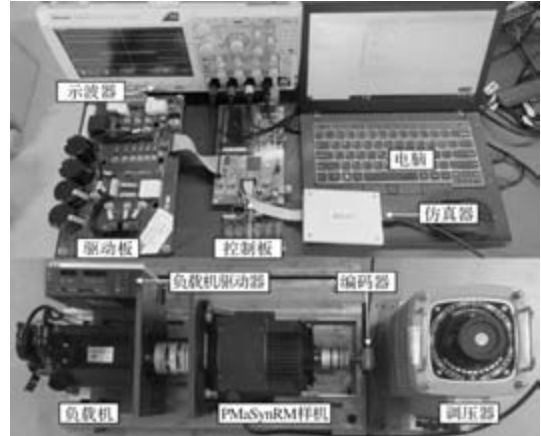
图 16 永磁辅助同步磁阻电机对拖试验平台
