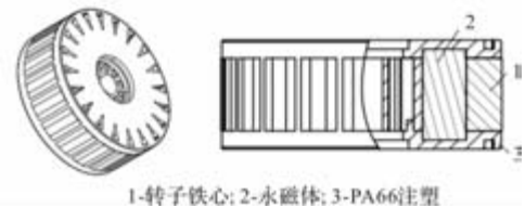
图 11 转子铁心包塑结构图
