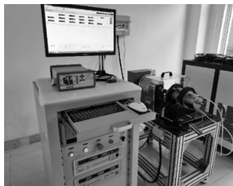
图 8 带有振幅测量的幅频特性及效率测功机
