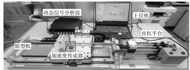
图 10 直线电机振动测试平台
