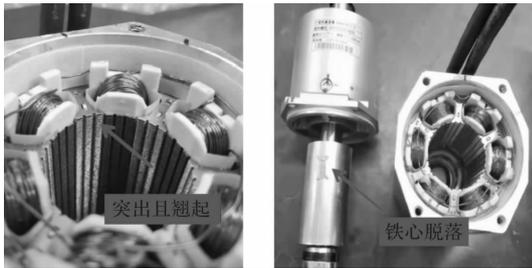
图 4 铁心脱落示意图
