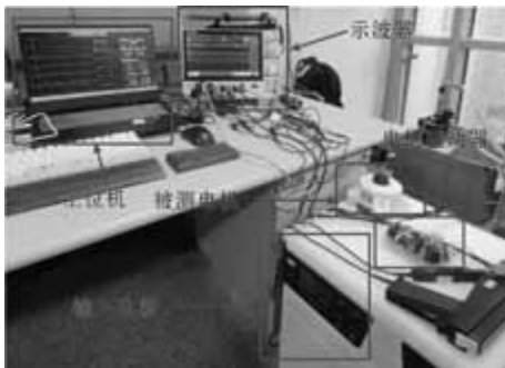
图 7 本文搭建的小功率电机参数辨识试验台
