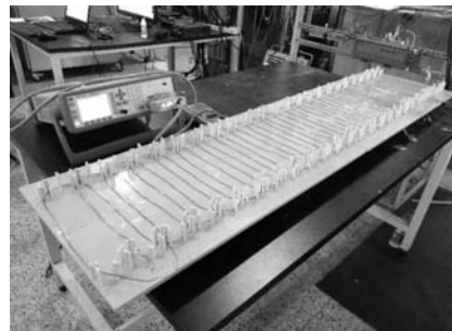
图 9 绕组电感测试实验装置
