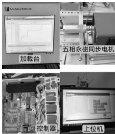
图 9 五相 PMSM 控制系统实验平台
