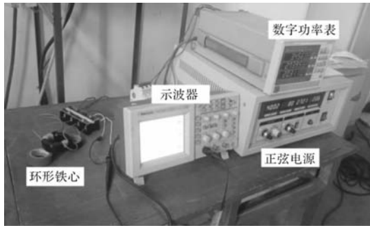
图 2 1J22 环形铁心实验测试装置
